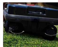
Napęd na 4 skrzętne koła 4 driving and steering wheels
