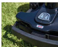
Miękki zderzak i czujniki przeszkód Bumper and soft obstacle sensor
