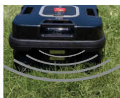
RADARY wykrywające przeszkody RADAR for obstacle detection
